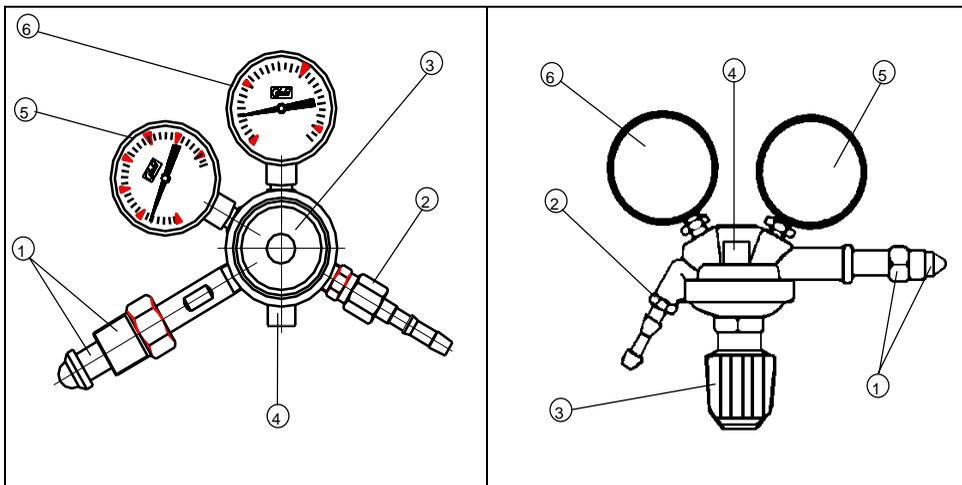
1.-Vástago y tuerca de acoplamiento. Zona de unión a la botella o canalización y entrada del gas a alta presión. Cada clase de gas dispone de un tipo diferente de acoplamiento.
