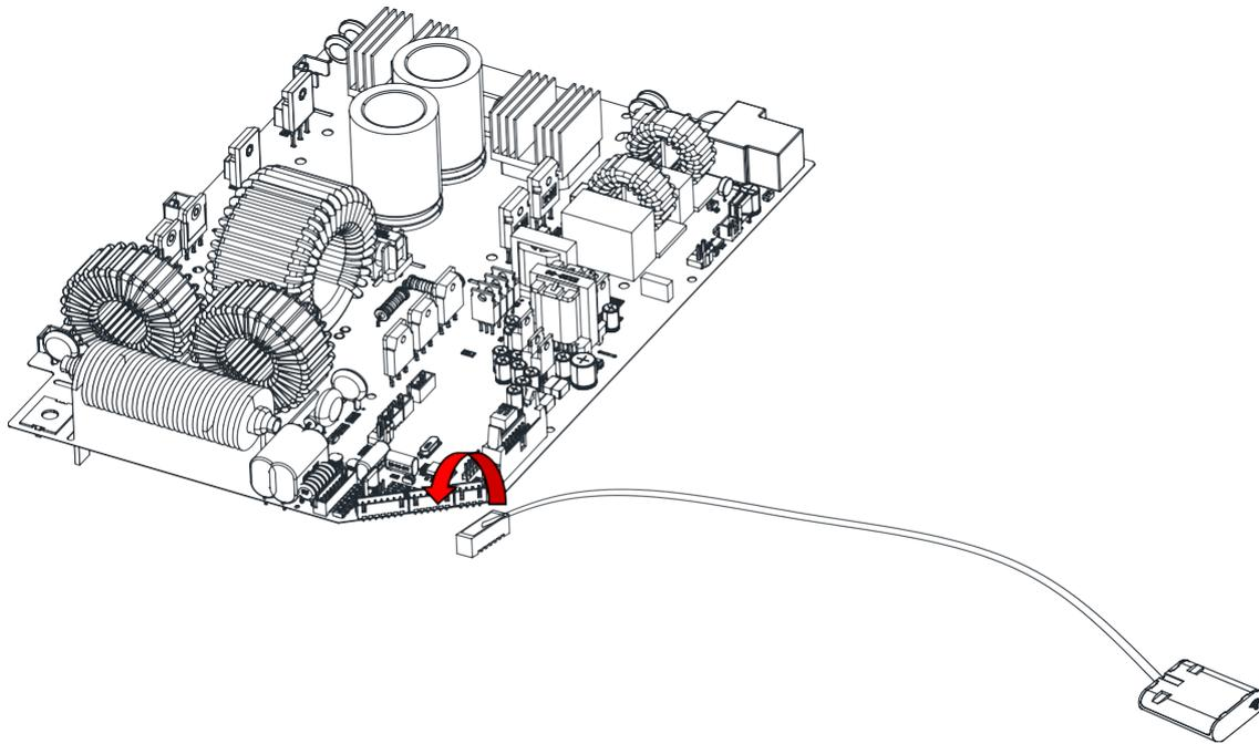
Diagrama esquemático para la inserción del terminal inalámbrico en la PCB del MMA
