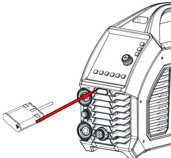
2) Inserte el terminal del módulo receptor inalámbrico.
