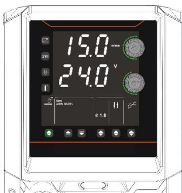
(Ajuste de la velocidad de avance del alambre y de la tensión)
