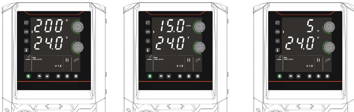
(Ajuste de la corriente de soldadura)
