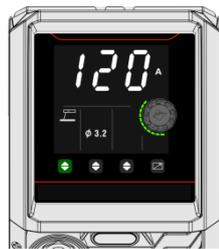
Tras seleccionar el diámetro del electrodo, el sistema seleccionará automáticamente la corriente de soldadura, la corriente de arranque en caliente y la fuerza del arco. Los usuarios pueden girar la perilla de ajuste de acuerdo con los requisitos de soldadura para ajustar con precisión los parámetros de la corriente de soldadura.
