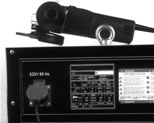
*En el panel posterior todos los modelos están equipados con una toma monofásica de 220 V para conexión de pequeñas herramientas eléctricas portátiles de apoyo al soldador o generadores de alta frecuencia para soldadura TIG.*
