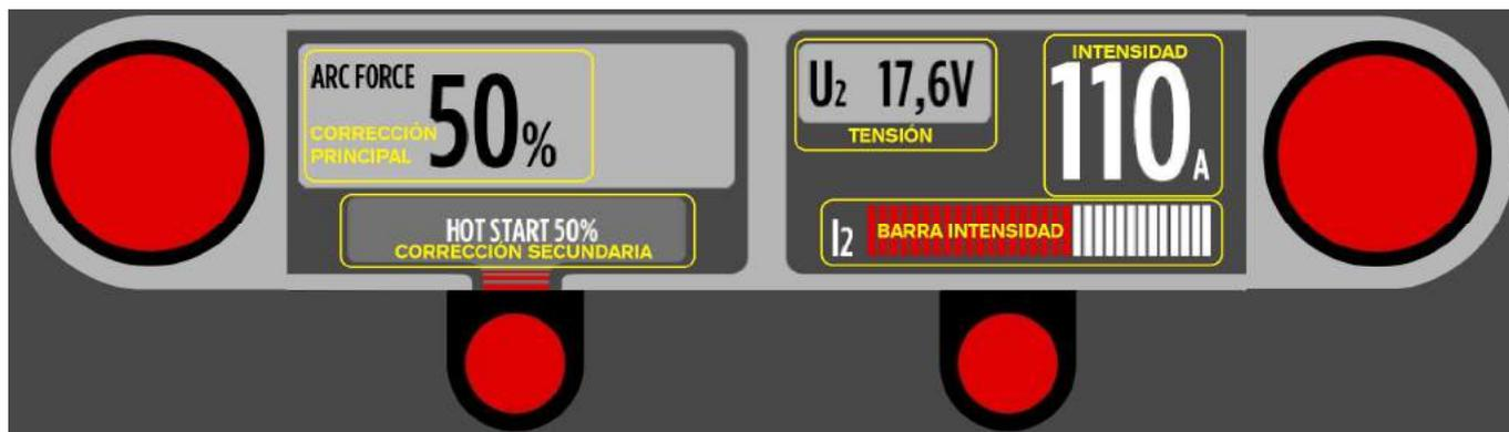
En proceso MMA dispondremos en pantalla del valor de tensión real, visualizando de esta manera los valores de tensión de vacío, tensión VRD o tensión de soldadura según corresponda.
