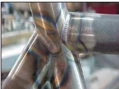
Con la finalidad de obtener mayor control sobre el aporte de soldadura se puede emplear corriente pulsada. El resultado es una sucesión de puntos que se solapan a modo de cordón, garantizando cada impulso la penetración y la solidificación parcial del mismo.
