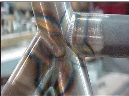
Ce procédé est adapté pour toutes les applications où il faut limiter l'apport thermique, que ce soit en épaisseur, déformation ou transformations métallurgiques.
