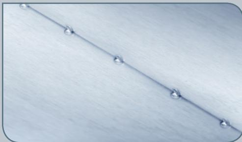
Il s'agit du procédé TIG le plus utilisé, et qui permet de souder la plupart des matériaux (aciers au carbone, aciers inoxydables, titane, bronze...), excepté l'aluminium et le magnésium.
