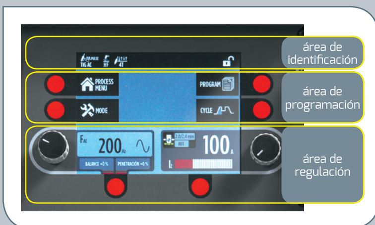
L'équipement intègre un système de contrôle numérique. Pour chaque procédé de soudage, il existe un paramétrage préfixé qui permet un réglage simple. Ce paramétrage peut être personnalisé en créant un programme d'utilisateur pouvant être intégré à la bibliothèque.
