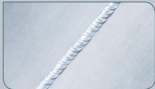
Ils sont utilisés dans le soudage de l'aluminium (et ses alliages) et du magnésium avec des courants élevés. Pendant le cycle positif, on obtient la cassure de l'oxyde qui recouvre le matériau, alors que pendant le cycle négatif l'électrode refroidit et favorise ainsi une bonne pénétration car elle augmente l'apport de chaleur dans la pièce soudée.
